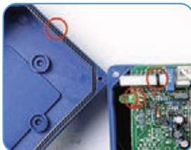
Βαθμός προστασίας IP65 και ηλεκτρικές μονώσεις class 2. Δεν απαιτείται εξωτερική γείωση.
