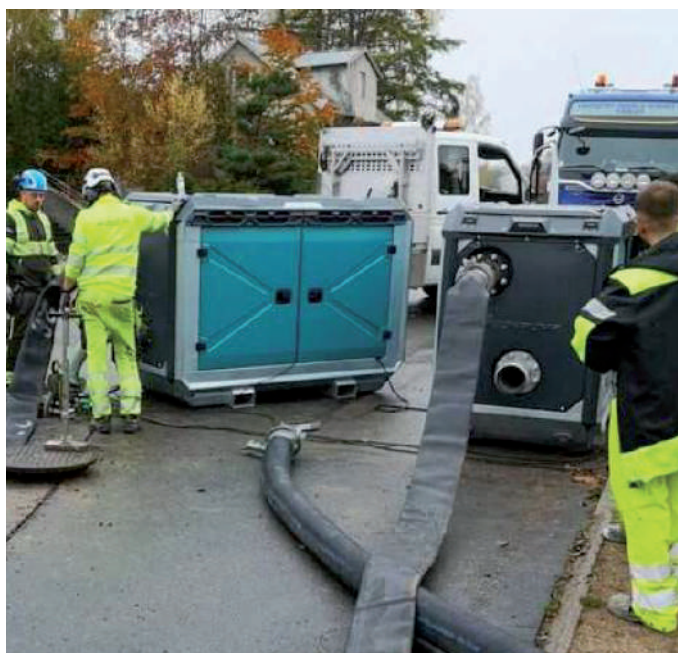
Διατίθενται επίσης, τα ίδια μοντέλα ως ηλεκτροκίνητα, με ενσωματωμένη μπαταρία Li-Ion και υδρογονοκίνητα με κυψέλες καυσίμου (Eccel Cells).
