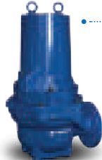
• Lowara 1320 Non-clog ~ ~ ~ ~ ~ παροχή 266 m 3 /h Μέγιστο μανομετρικό 41 m Εύρος ι' χύος 3.5 - 7.5 kW Έξοδος 80 - 100 mm Βάρος 130 - 156 kg
