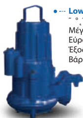
• Lowara 1305 Non-clog ~ ~ ~ ~ ~ παροχή 50 m 3 /h Μέγιστο μανομετρικό 17 m Εύρος ι' χύος 0.75 - 1.2 kW Έξοδος 50 mm Βάρος 30 kg
