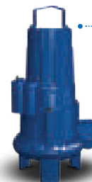
• Lowara 1310 Non-clog ~ ~ ~ ~ ~ παροχή 65 m 3 /h Μέγιστο μανομετρικό 25 m Εύρος ι' χύος 1.4 - 2.4 kW Έξοδος 50 - 80 mm Βάρος 46 kg
