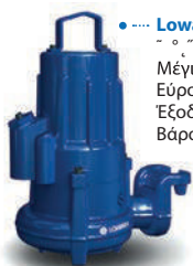
Lowara 1315 Non-clog ~ ~ ~ ~ ~ παροχή 194 m 3 /h Μέγιστο μανομετρικό 30 m Εύρος ι' χύος 1.8 - 4.4 kW Έξοδος 80 - 100 mm Βάρος 95 kg
