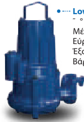
• Lowara 1320 Non-clog ~ ~ ~ ~ ~ παροχή 266 m 3 /h Μέγιστο μανομετρικό 41 m Εύρος ι' χύος 3.5 - 7.5 kW Έξοδος 80 - 100 mm Βάρος 130 - 156 kg
